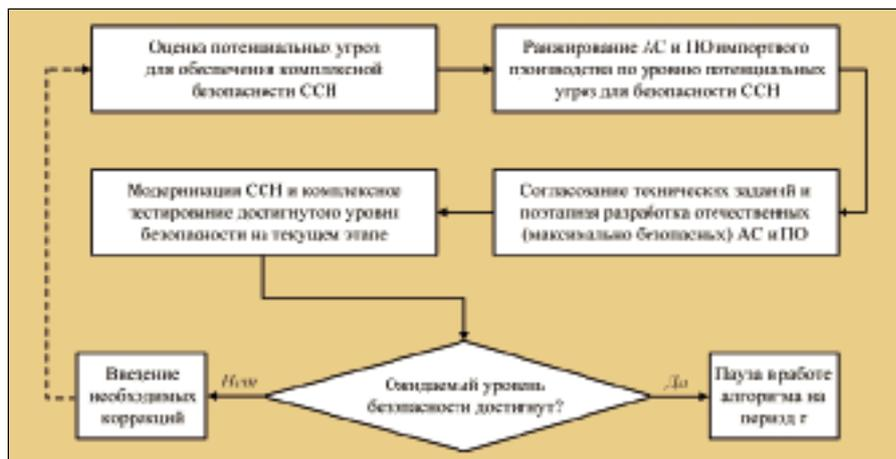
Рис. 2. Алгоритм достижения максимального уровня безопасности ССН
