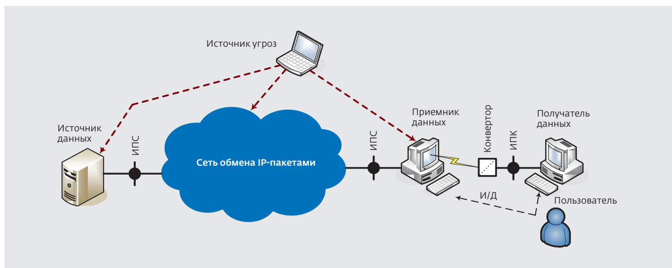
Рис.5. Структура тракта обмена информацией [18]
