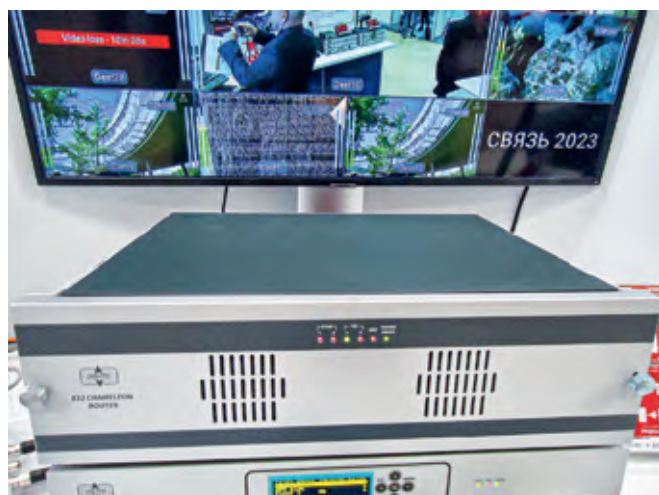
Автономный коммутатор 3G/HD/SD-SDI, ASI – новая разработка компании "ПРОФИТТ"
