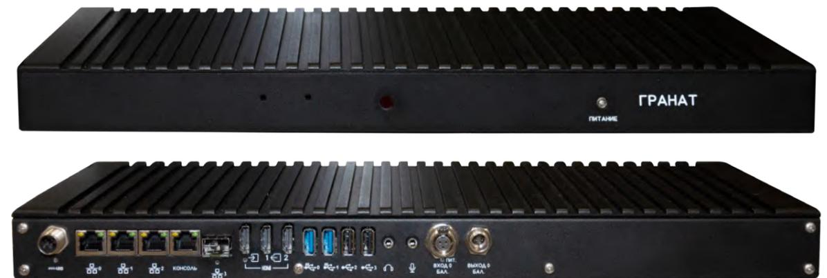
«ГРАНАТ-СМ», являясь центральным модулем платформы, обеспечивает управление параметрами работы модулей МВЗ и МВТ, направляя управляющие команды, устанавливающие:
