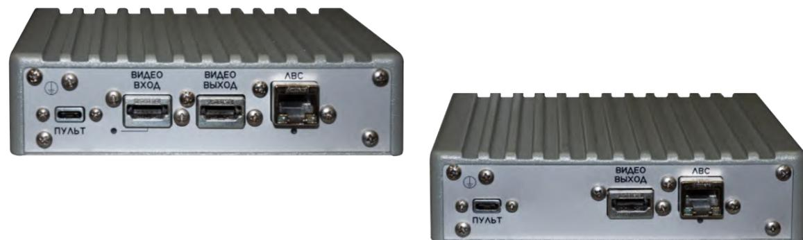
В процессе своей работы «ГРАНАТ-СМ» обеспечивает прием видеопотоков от модулей MB3 и перераспределяет их между модулями MBT. При необходимости на один MBT может направляться несколько видеопотоков.
