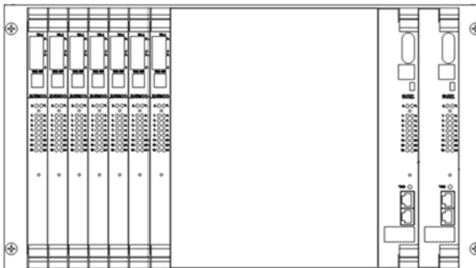
Рисунок 11 — Схема расположения 2 плат Zeus–STM1 и 7 плат Consul
