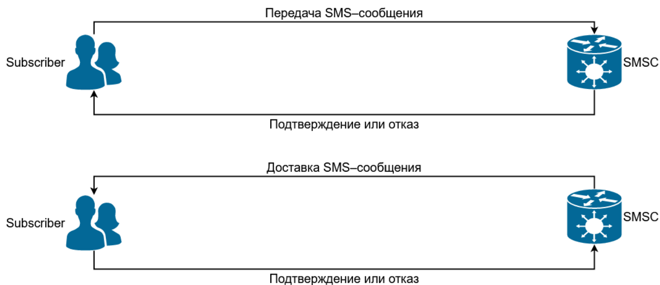
Рисунок 1 — Процедура передачи коротких сообщений
